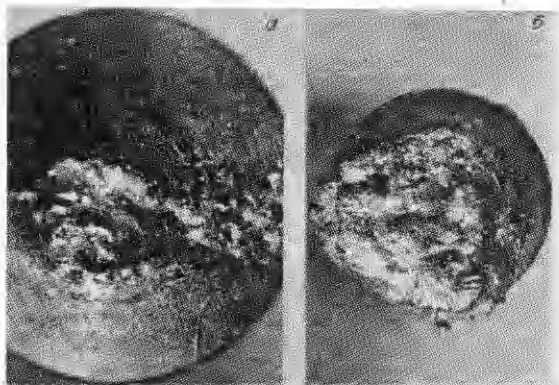
Рис. 4. Вид поверхности разрушения образцов нержавеющей стали после их разрыва в кислороде ( p = 10 МПа, нагрев током, T_s^* = 1303 К).
