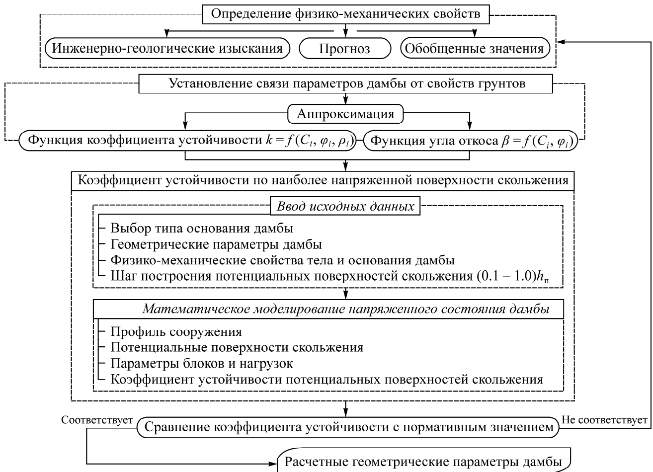
Рис. 5. Алгоритм аналитического метода прогноза устойчивости дамбы
