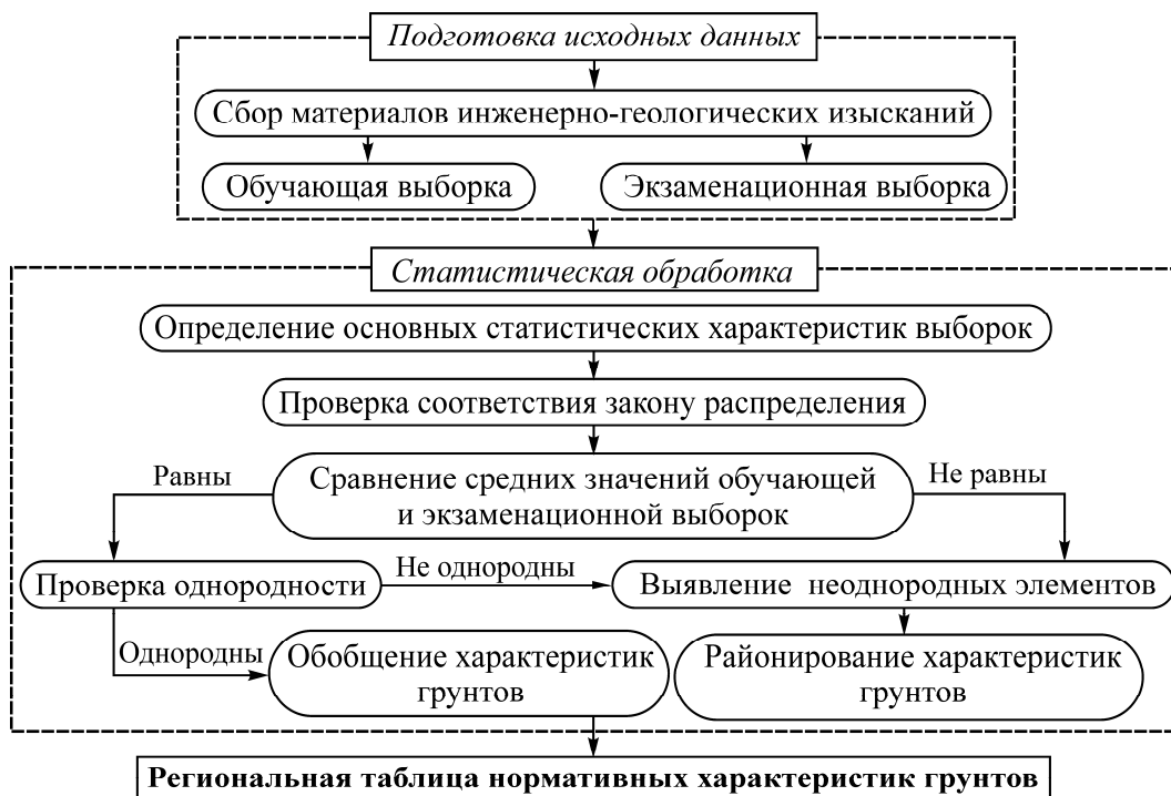
Рис. 2. Схема анализа и обобщения физико-механических характеристик грунтов
