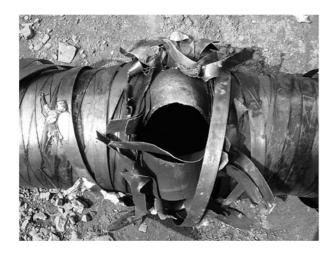
Рис. 2. Разрыв камеры I
