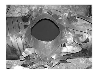
Рис. 4. Разрыв камеры III
