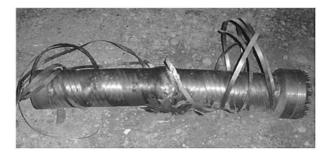
Рис. 5. Камера III после опыта с зарядом массой 450 г
