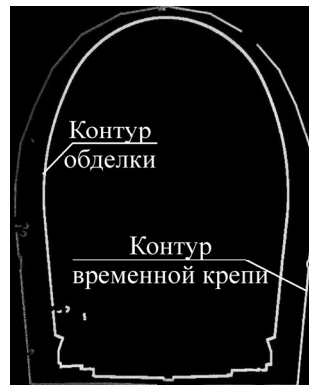
Рис. 5. Пример совмещения сканов поперечного контура обделки и временной крепи для контроля осадки бетона
