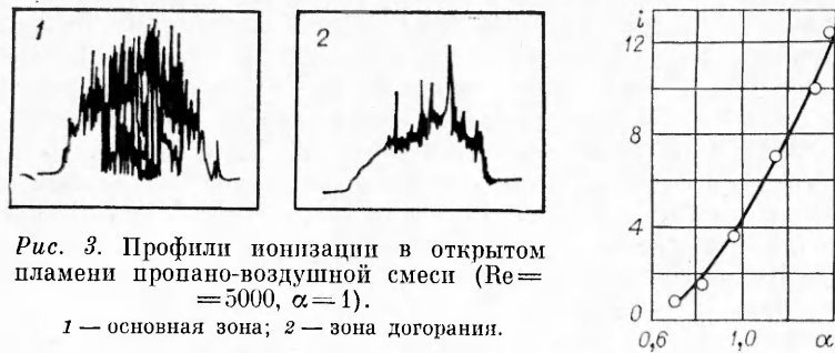
Рис. 4. Зависимость i = \text{СН}^*/\text{С}_2^* от \alpha в ламинарном пламени пропано-воздушных смесей.
