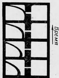
Рис. 1. Распространение пламени вблизи канала высотой 2,5 мм. Кадры следуют через 7,8 мс.
