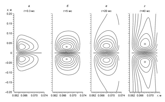
Рис. 3. Изолинии  $H_r$  (A/м) в ферромагнитном проводнике для  $\mu = 100$ .
