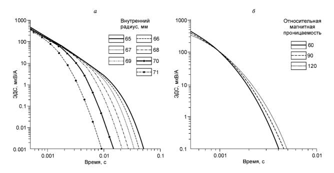
Рис. 5. Зависимость ЭДС в вертикальных рамках: a — от внутреннего радиуса цилиндра,  $\delta$  — от магнитной проницаемости цилиндра.
