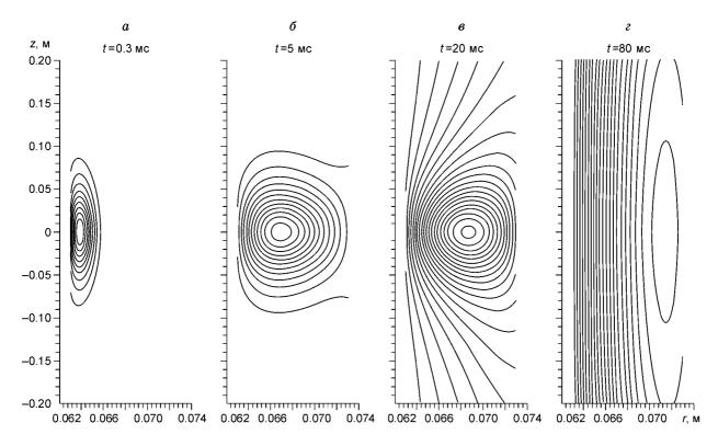
Рис. 2. Изолинии плотности тока  $j_{\phi}$  (A/м²) в ферромагнитном проводнике для  $\mu = 100$ .
