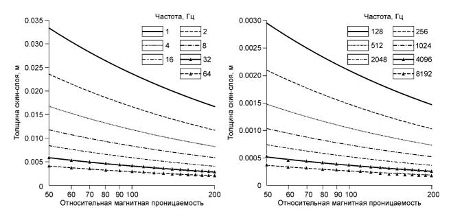
Рис. 7. Толщина скин-слоя в зависимости от магнитной проницаемости цилиндра.
