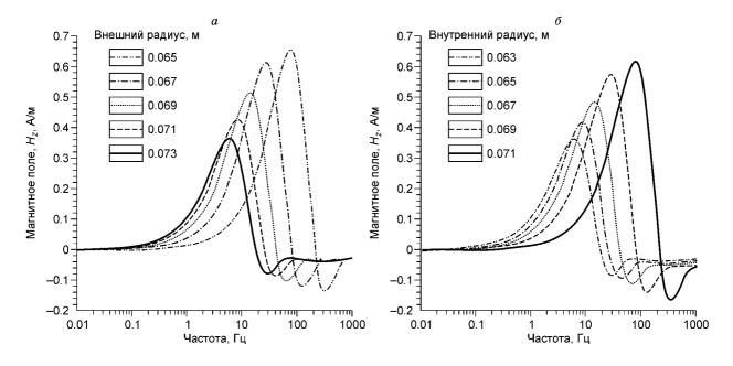
**Рис. 8. Зависимость гармонического поля от толщины стенки цилиндра:** a — при изменении внешнего радиуса ( $r_1$  = 0.063 м);  $\delta$  — при изменении внутреннего радиуса ( $r_2$  = 0.073 м).
