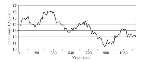
Puc. 8. Зависимость вертикального смещения ЦМ ролика от полярного угла
