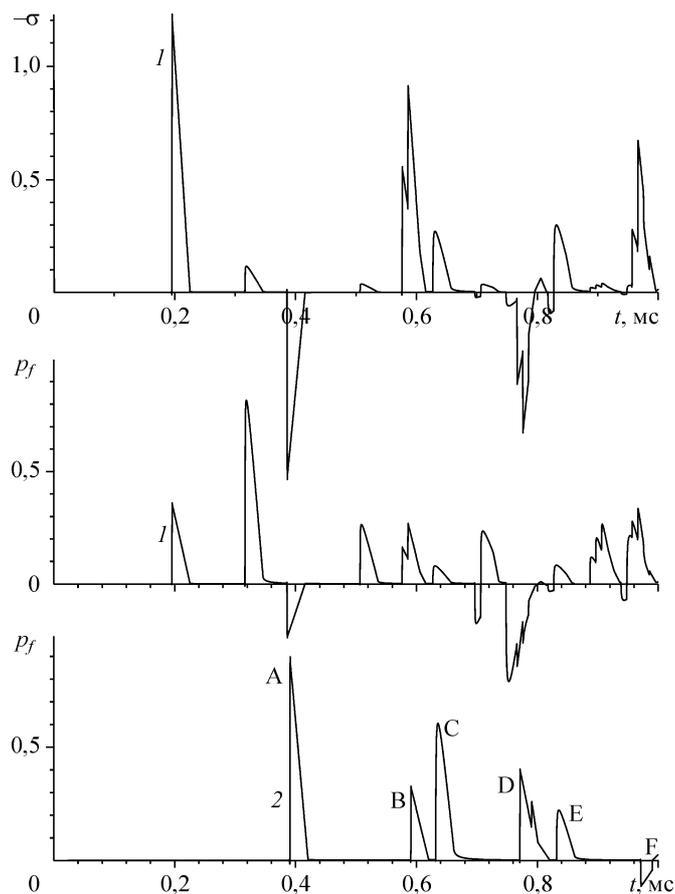
Рис. 5. Зависимости от времени полного напряжения  $\sigma$  и давления жидкости  $p_f$  внутри пористого слоя (1,  $x = 0,25$  м) и на стенке (2,  $x = 0,65$  м).
