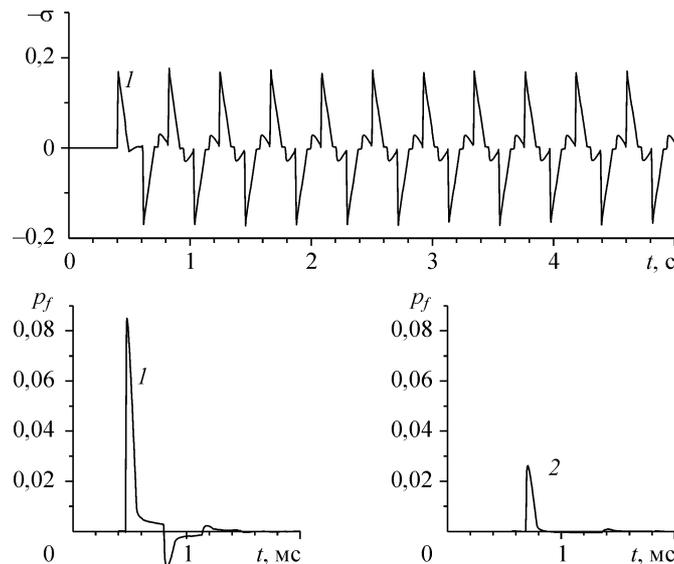
Рис. 3. Зависимости от времени полного напряжения  $\sigma$  и давления газа  $p_f$  внутри пористого слоя (1,  $x = 0,05$  м) и на стенке (2,  $x = 0,14$  м).
