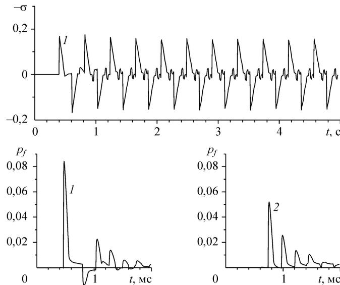
Рис. 4. Зависимости от времени полного напряжения  $\sigma$  и давления газа  $p_f$  внутри пористого слоя (1,  $x = 0,05$  м) и на стенке (2,  $x = 0,14$  м).
