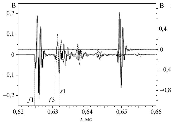
Рис. 6. Сопоставление экспериментальных [21] и расчетных данных для частоты 1 МГц. Сплошные линии соответствуют экспериментальным, штриховые — расчетным данным.
