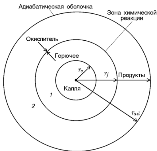
Рис. 1. Горение капли жидкого горючего в адиабатической оболочке
