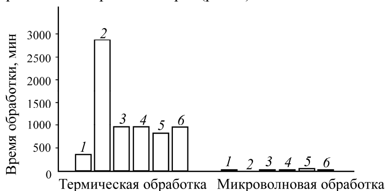
Рис. 1. Сравнение термической и микроволновой обработки: 1 — окисление органической матрицы (углистые сланцы); 2 — окисление органической матрицы (угли); 3 — сушка, растворение (железомарганцевые конкреции); 4 — окисление серы (сульфидные руды); 5 — разрушение силикатной матрицы (почва, пыли); 6 — растворение в смеси кислот (особо чистые вещества Nb, Ta и т. д.)
