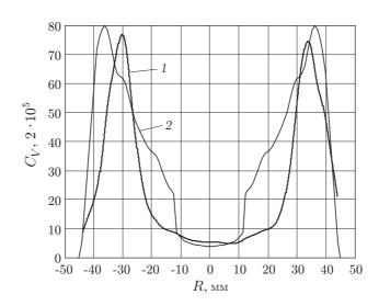
Puc.~2. Распределение концентрации капель воды по радиусу факела центробежной форсунки на расстоянии Y=40 мм,  $\Delta P=8$  бар (кривая 1 — метод флуоресценции, 2 — метод рассеяния на малые углы)
