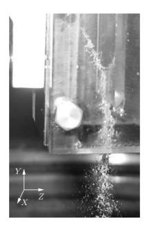
Puc. 4. Струя топлива в плоском канале в сносящем потоке воздуха
