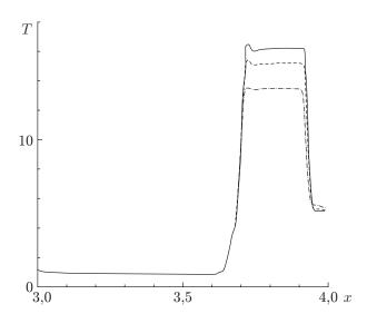
Рис. 1. Распределение температуры вдоль профиля: сплошная линия — модель идеального газа, штриховая — модель газа с учетом возбуждения колебаний молекул, штрихпунктирная — модель [10]
