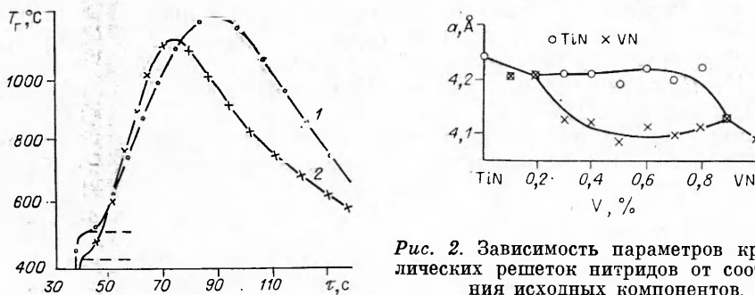
Рис. 1. Температурные профили горения шихты составов Ti 0,3 (VH v ) 0,7 (1) и Ti 0,2 (VH v ) 0,8 (2) при \mu_{N_2} = 10 \text{ атм} (штриховыми линиями показана область разложения VH v ).
