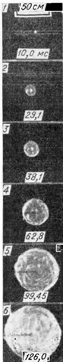
Рис. 1. Кинокадры процесса сгорания смеси 10% \text{CH}_4 + 10\% воздуха; p_0 = 100 кН/м 2 ; T_0 = 288 К.
