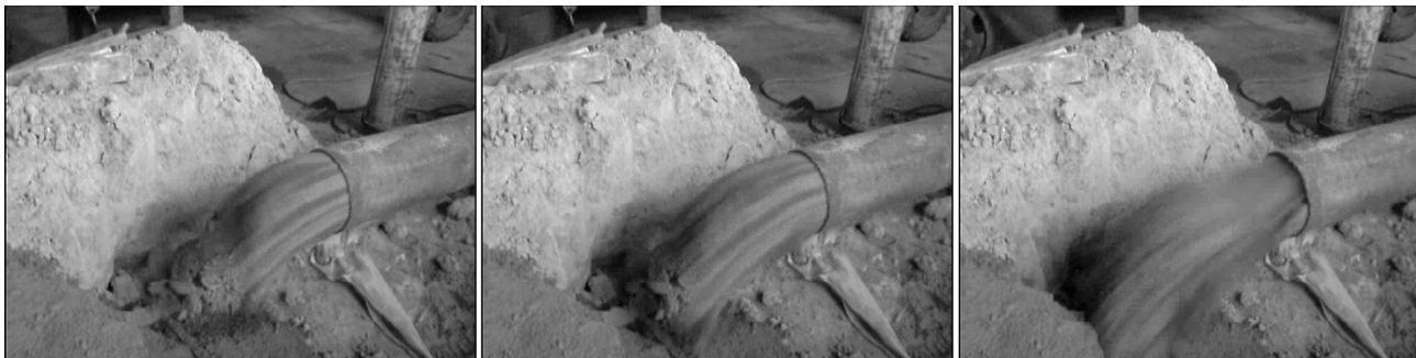
Рис. 4. Начальная, средняя и конечная фазы выхода порции грунта
