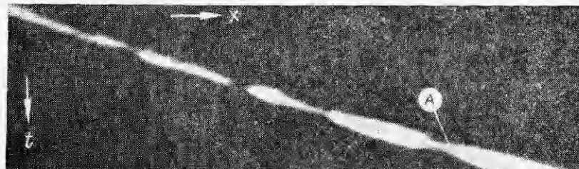
Рис. 2. Фоторегистрограмма распространения детонационной волны в суспензионном ВВ. Диаметр заряда 180 мм. Материал оболочки заряда — полиэтилен. Инициирование в режиме нормальной детонации плосковолновым генератором ударных волн; A - l_2 = 2000 мм.
