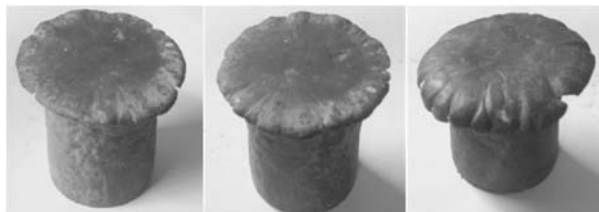
Рис. 5. Фотографии крешеров из свинца, осажденных взрывом ЭмВВ типа GM, GM/Al и водородного типа (слева направо)
