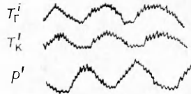
Рис. 6. Осциллограммы колебаний давления и яркостной температуры (светимости) в выходном сечении камеры сгорания ( T_{\text{вх}} = 423 \div 429 \text{ К} , p_{\text{к}} = 392 \text{ кПа} , v = 0,793 \div 0,803 \text{ м}^3/\text{с} ).
