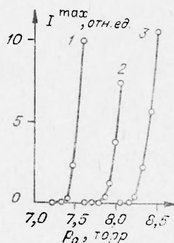
Рис. 4. Зависимость максимальной интенсивности хемилюминесценции от начального давления при молярных долях H_2 , равных: 1 — 0,05 (по данным работы [12]); 2 — 0,03; 3 — 0,02.
