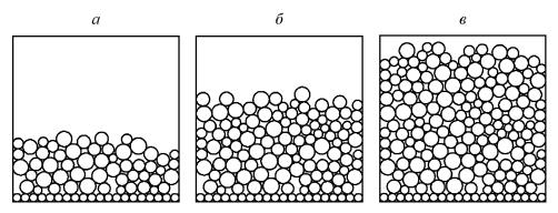
Рис. 1. Схема процесса гравитационного уплотнения зерен
