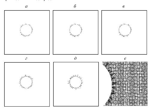
Рис. 6. Распределение максимального главного напряжения в условиях растяжения на схемах 1-3: a-в, e — схема 1 и временной шаг 5000,  $10\,000$ ,  $30\,000$ ,  $30\,000$  соответственно после образования тоннеля; e — схема 2 и временной шаг  $30\,000$ ; e — схема 3 и временной шаг  $30\,000$
