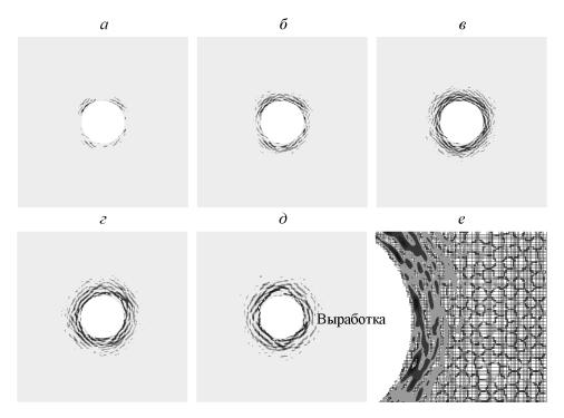
Рис. 5. Распределение минимального главного напряжения на схемах 1-3: a-6, e — схема 1 и временной шаг 5000,  $10\,000$ ,  $30\,000$ ,  $30\,000$  соответственно после выемки тоннеля (выработки); e — схема 2 и временной шаг  $30\,000$ ; e — схема e и временной шаг e e000.
