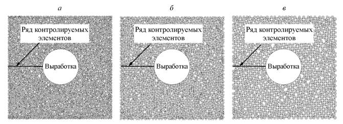
Рис. 2. Модели "зерно – поверхность контакта – матрица" разного радиуса: a — схемы 1, 4 и 5;  $\delta$  — схема 2;  $\epsilon$  — схемы 3, 6, и 7
