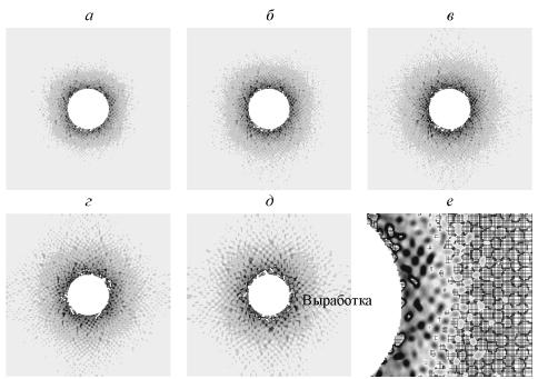
Рис. 4. Распределение деформации сдвига в схемах 1-3: a-в, e — схема 1 и временной шаг 5000, 10 000, 30 000, 30 000 соответственно; e — схема 2 после образования выработки и временной шаг 30 000; e — схема 3 и временной шаг 30 000
