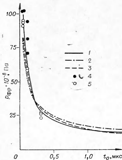
Рис. 3. Зависимость критических параметров инициирования состава ТГ 50/50 от длительности действия импульса.
