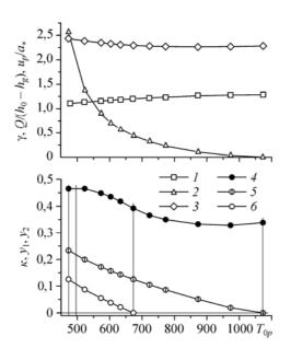
полного давления в сравнении с переохлажденной смесью. С увеличением влажности в камере рост коэффициента эжекции замедляется. При температуре пара меньше 495 К небольшое количество влаги появляется во входном сечении горла эжектора. Ее влияние на течение в горле в расчете не учитывается. Коэффициент эжекции достигает максимального значения k = 0,465 при температуре пара перед соплом 473 К. При этой температуре пар становится насыщенным на входе в сопло.
