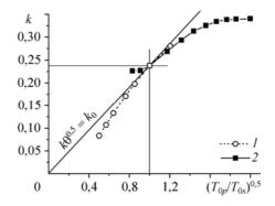
точные значения приведенной скорости  $\lambda_2$  в сечении полного перемешивания и коэффициентов эжекции получаются меньше приближенных. Снижение коэффициентов эжекции достигает 8–8,5 % при двукратном различии температур рабочего и низконапорного газов в ту или другую сторону.
