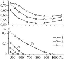
коэффициента эжекции в паровом эжекторе при наличии влаги в камере значительно меньше (на 71 %). Из представленных примеров видно, что использование паровых эжекторов наиболее выгодно при повышенных температурах низконапорного газа.
