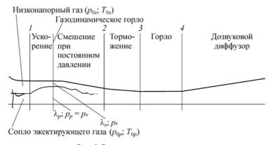
Рис. 1. Расчетная схема эжектора.
