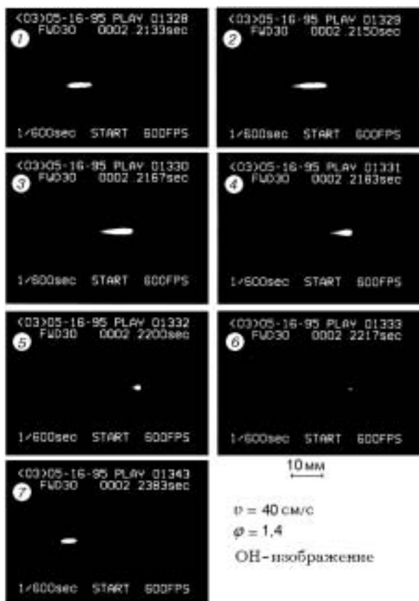
Рис. 4. Последовательные снимки, сделанные скоростной камерой в ультрафиолетовом диапазоне
