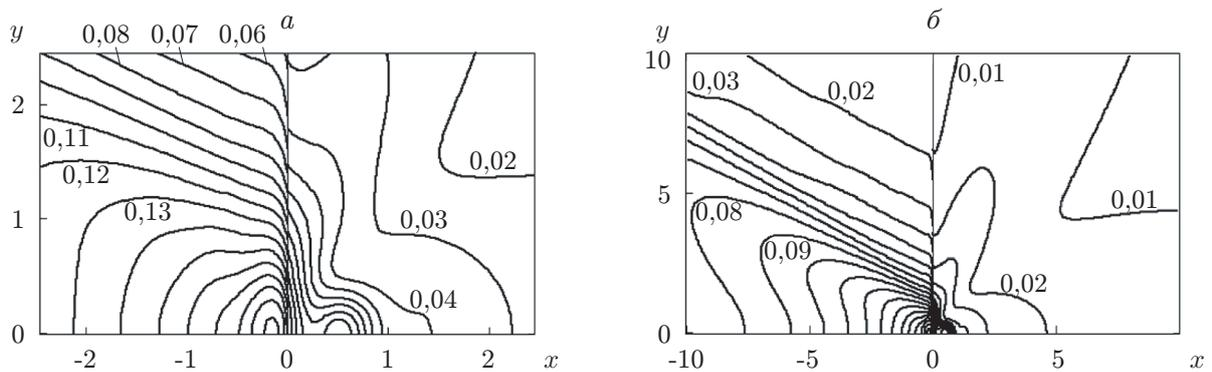
Рис. 6. Изолинии амплитуд возвышения жидкости (*слева*) и прогиба пластины (*справа*) при  $\omega = 1 \text{ с}^{-1}$ ,  $H = 100 \text{ м}$  с шагом 0,01 (на пластине — от 0,01 до 0,12, в жидкости — от 0,02 до 0,20):
