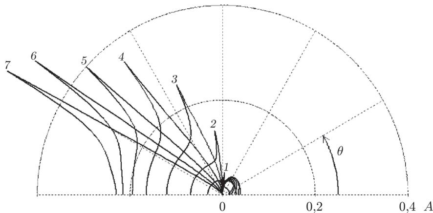
Рис. 4. Главный член асимптотики амплитуд прогиба пластины и возвышения жидкости в дальнем поле (функция  $A(\theta)$ ) при различных значениях частоты:
