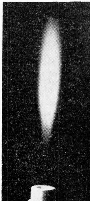
Рис. 3. Фотография пламени водорода в сверхзвуковом ( M=1,58 ) спутном потоке.
