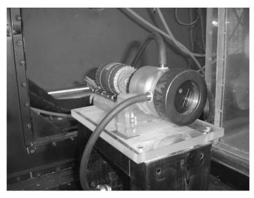
Рис. 1. Цилиндрическая модель с устройством, задающим частоту смешения воды
