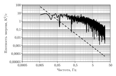
Puc. 6. Энергетический спектр пульсаций воды в Т-образном соединении. Обработка термографических данных
