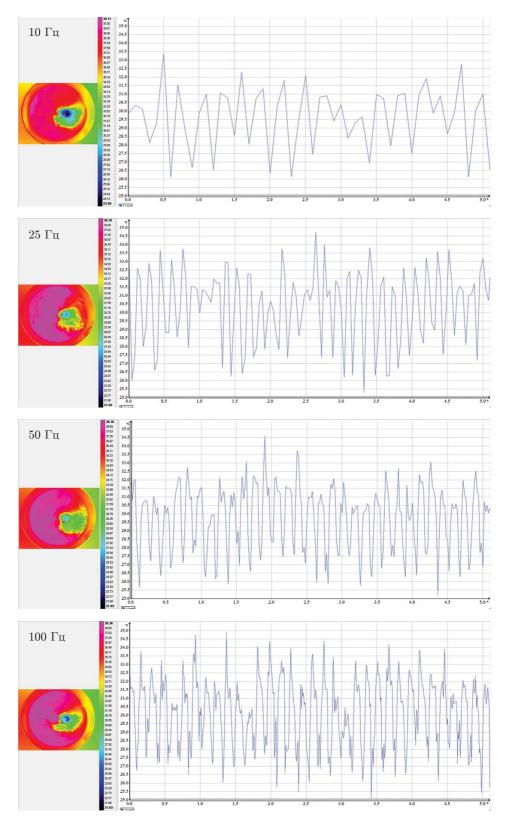
$Puc.\ 3.$  Температурные пульсации при смешении воды, снятые через прозрачное для ИК-излучения окно при разных частотах регистрации
