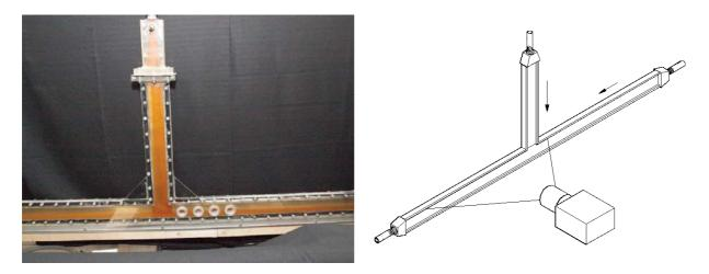
Puc. 4. Т-образное соединение для смешения потоков воды
