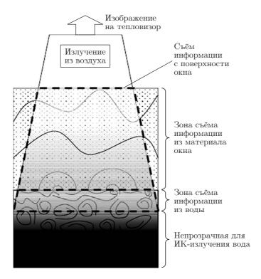
Рис. 2. Зоны съёма информации тепловизором
