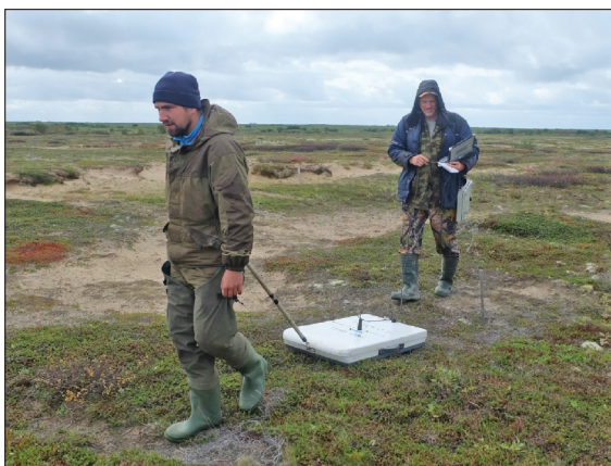
Рис. 2. Георадиолокационное профилирование (а) и бурение скважины (б) на участке исследования.
