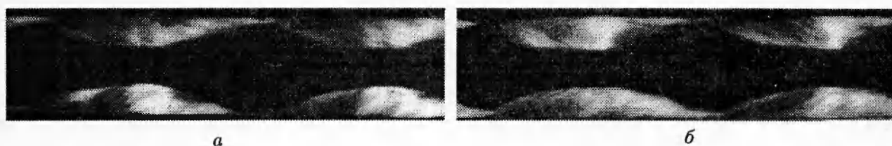
Рис. 2. Фоторегистрограммы процесса с радиальными волнами через радиальные окна
