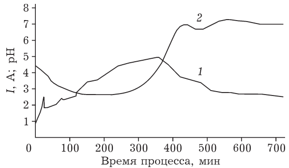
Рис. 3. Динамика изменения силы тока I (1) и pH (2) при окислении модельной смеси растительных отходов.
