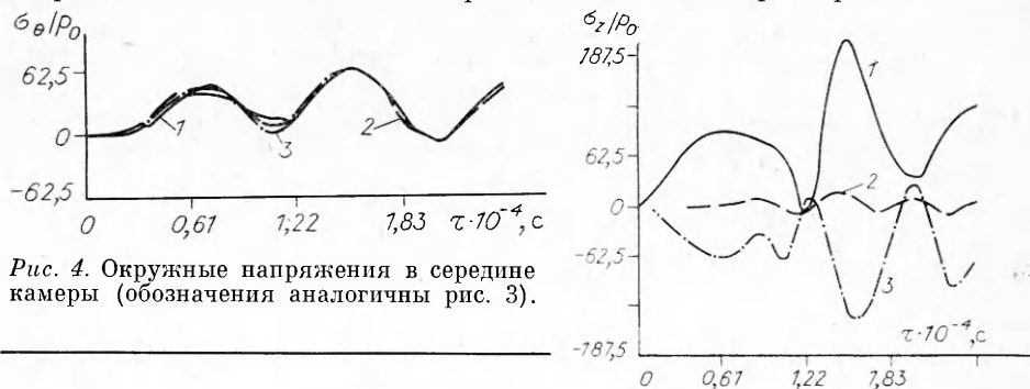
Рис. 5. Осевые напряжения на торце, где производится инициирование (обозначения аналогичны рис. 3).
