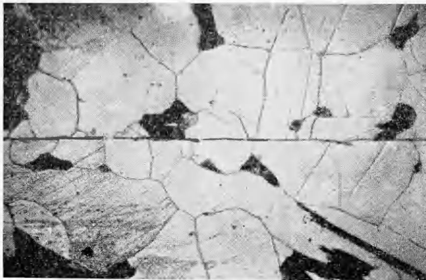
Рис. 2. Микрофотография сварного соединения № 4; \gamma=3^\circ , v_k=3000 м/с; \times 400 .
