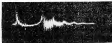
Рис. 4. Осциллограмма давления при вбрасывании в пузырь распыла воды. Длительность развертки 30 мс; P_1=4,4 бар.
