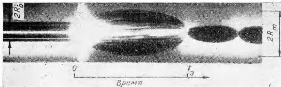
Рис. 3. Теневая фоторегистрограмма пульсаций пузыря при взрыве смеси 2\text{H}_2+\text{O}_2 ; R_0=2,4 см, R_m=5,3 см, T_3=11 мс.
