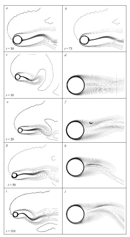
*Рис. 3. а, b* — линии равных значений завихренности для  $T_s=40$  °C,  $N_\xi=160$ ; c,e,g,i — линии равных значений завихренности для  $T_s=40$  °C,  $N_\xi=320$ ; d,f,h,j — линии равных значений температуры для  $T_s=40$  °C,  $N_\xi=320$ .
