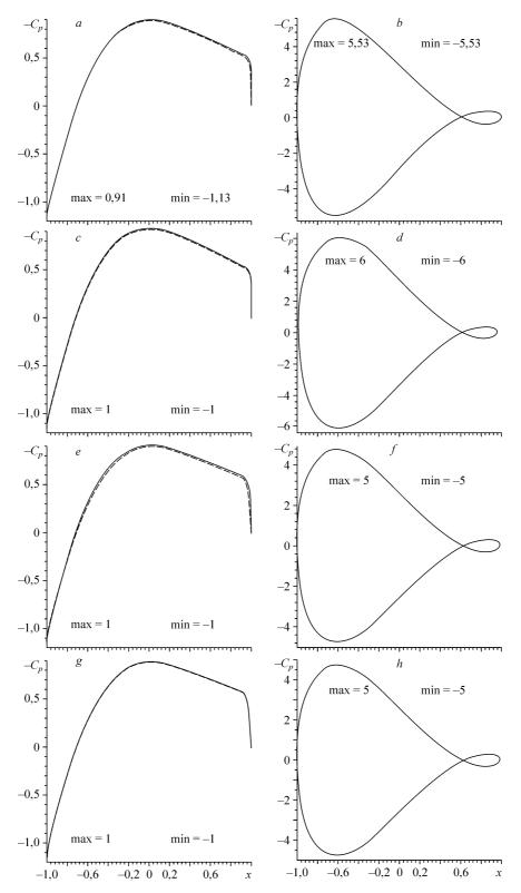
*Рис. 2. а, c, e, g* — распределение коэффициента давления  $C_p = (p-p_\infty)/(2\rho U^2)$ ; b, d, f, h — распределение завихренности  $\Omega_S$  по поверхности цилиндра.
