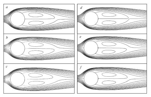
Puc. 4. Линии тока  $\Psi_i=(i-1)\cdot 0,025-0,25,\ i=1,\ 2,\ \dots,\ 21$  в течении при  $T_S=21$  °C,  $N_\xi=620,\ R_\infty=40$  R в разные моменты времени: для воды t=175,77  $(a),\ 188,78$   $(b),\ 211,30$  (c) и для воздуха t=105,98  $(d),\ 144,49$   $(e),\ 157,50$  (f).
