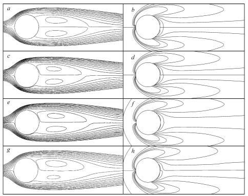
*Рис. 1. а, с, е, g* — линии тока  $\Psi_i = (i-1)\cdot 0,025-0,25, i=1,2,...,21; b, d, f, h$  — линии равной завихренности  $\Omega_j = (j-1)\cdot 0,25-1,25, j=1,2,...,11; \Omega_k = (k-1)\cdot 20-50, k=1,6.$
