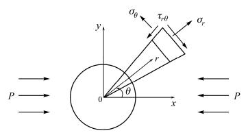
Рис. 1. Расчетная схема механического состояния массива горных пород в окрестности выработки
