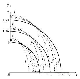
Рис. 4. Смещения дуг окружностей  $r=1,\ 1.36,\ \sqrt{3}$  : кривым  $l,\ 2,\ 3$  соответствуют  $E_2=E_1$  ,  $E_2=1.5E_1$  ,  $E_2=2E_1$  при длине трещины l=0.36
