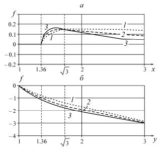
Рис. 5. Эпюры функции f: кривым l, 2, 3 соответствуют  $E_2 = E_1$ ,  $E_2 = 1.5E_1$ ,  $E_2 = 2E_1$  при длине трещины l = 0.36: a — на y = 0;  $\delta$  — на x = 0
