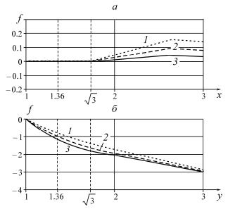
Рис. 6. Эпюры функции f: кривым l, 2, 3 соответствуют  $E_2 = E_1$ ,  $E_2 = 1.5E_1$ ,  $E_2 = 2E_1$  при длине трещины l = 0.36: a — на y = 0;  $\delta$  — на x = 0
