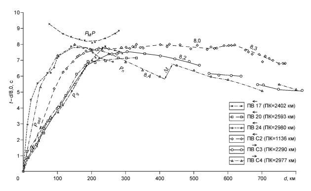
Рис. 2. Редуцированные годографы волн, зарегистрированных от химических (ПВ 17, 20, 24) и ядерных (ПВ C2, C3 и C4) источников на профиле "Кратон".
