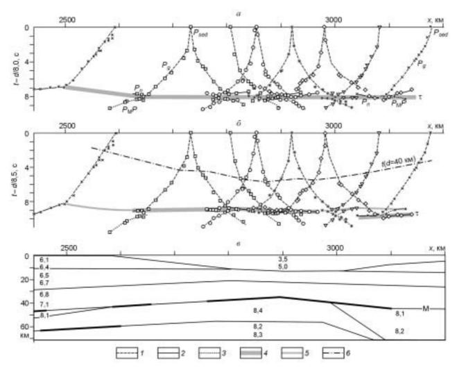
Рис. 6. Редуцированные годографы со скоростями редукции  $V_r = 8.0~(a)$  и  $8.5~{\rm km/c}~(\delta)$  и скоростной разрез земной коры и верхов мантии (s) по профилю "Кратон" в районе Вилюйской синеклизы.
