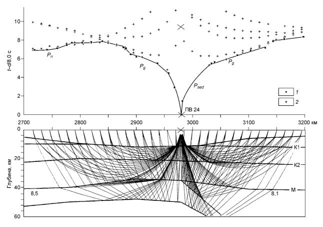
Рис. 7. Пример расчетов лучей и годографов преломленных волн в верхах мантии для ПВ 24 (химический взрыв), район Вилюйской синеклизы.
