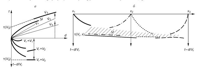
Рис. 5. Пояснения к методике построения временного разреза  $\tau(V,x)$ .
