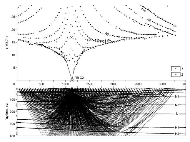
Рис. 9. Пример расчетов лучей и годографов волн, распространяющихся в верхней мантии вдоль профиля "Кратон", ПВ С2 (ядерный взрыв).
