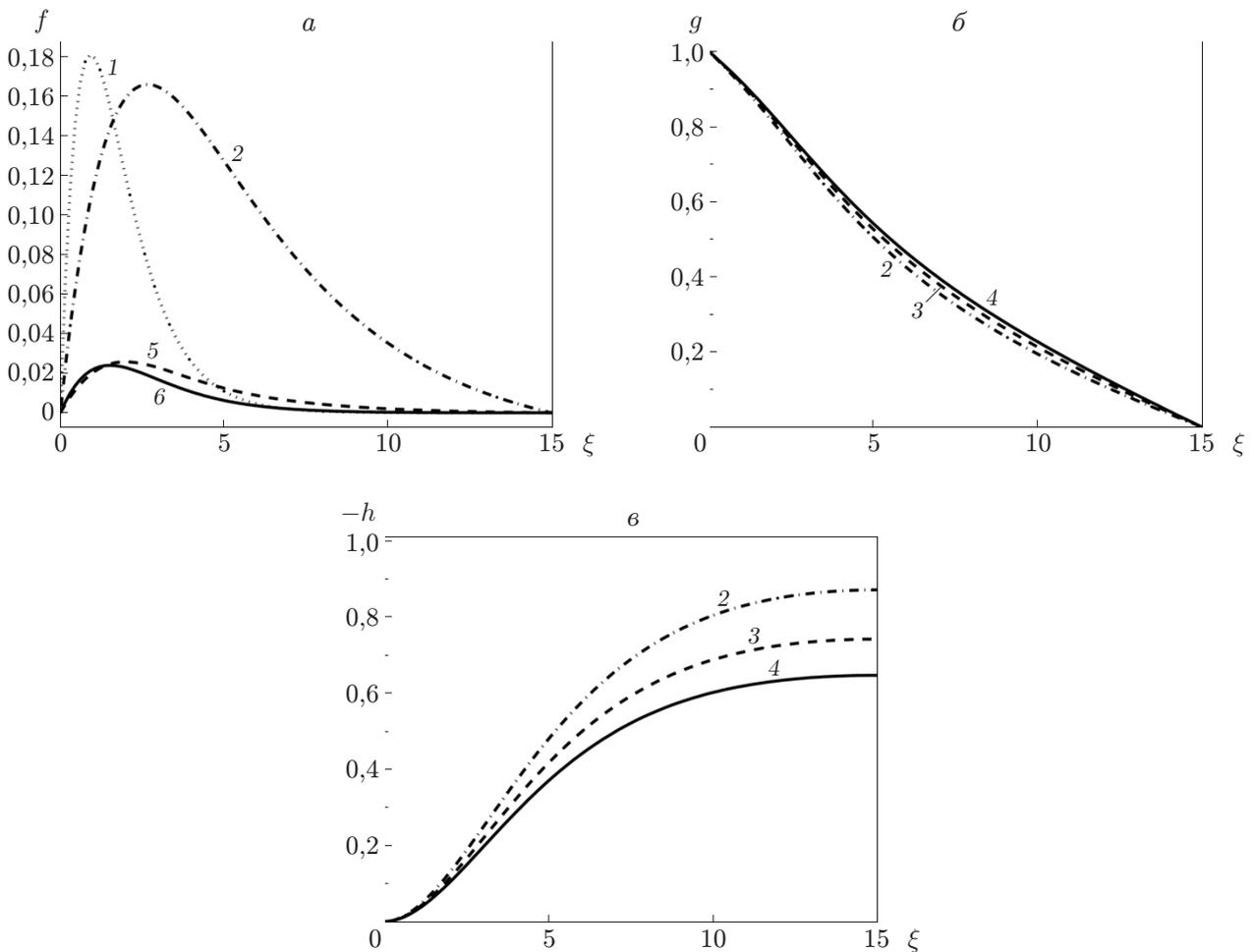
Рис. 4. Зависимости радиальной (*a*), тангенциальной (*б*) и осевой (*в*) составляющих вектора скорости от координаты  $\xi$  при различных значениях параметра продолжения  $M$ :
