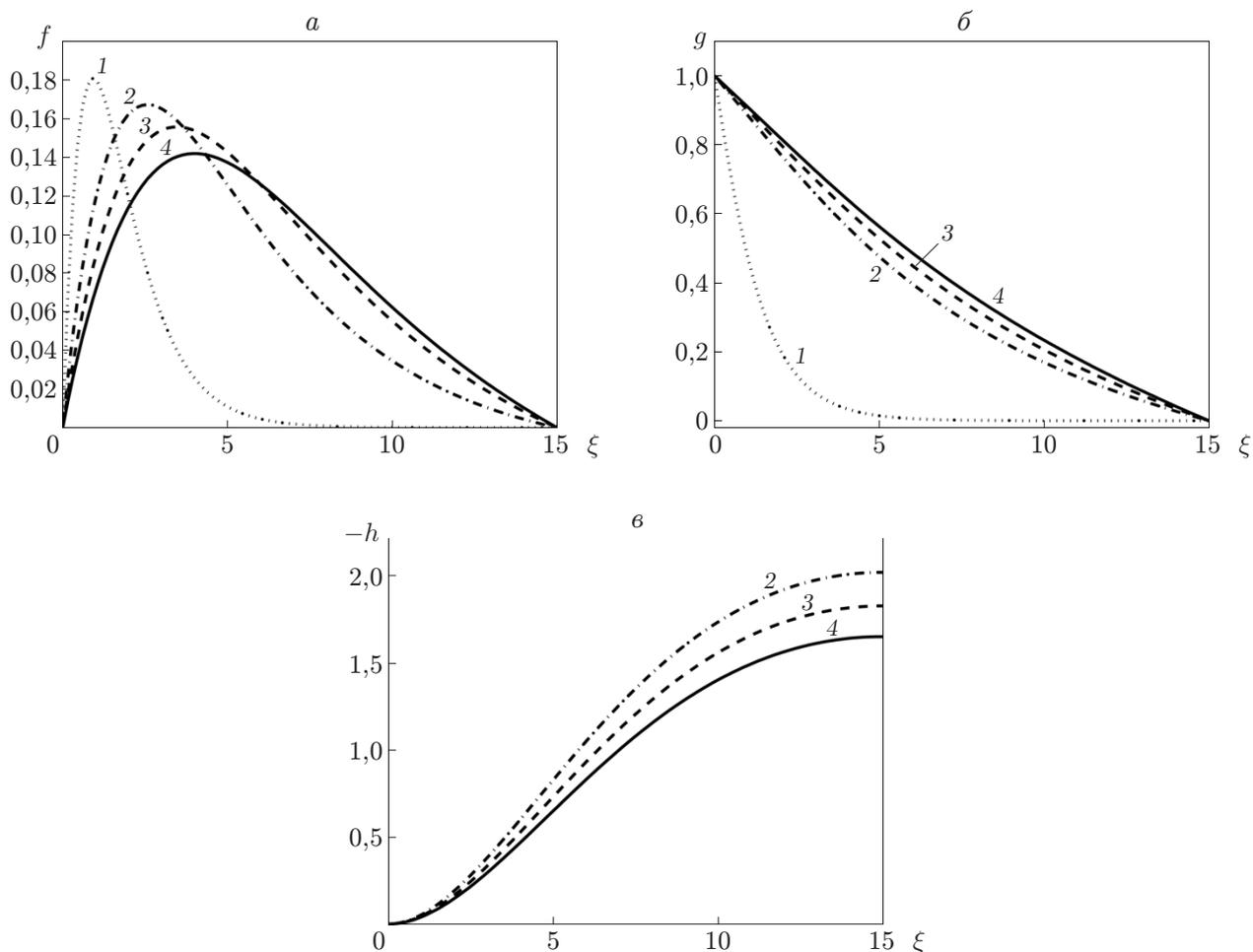
Рис. 2. Зависимости радиальной (а), тангенциальной (б) и осевой (в) составляющих вектора скорости от координаты  $\xi$  при различных значениях числа Бингама:
