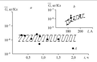
Рис. 7. Зависимость удельной эрозии анода от времени испытаний (a) и тока дугового разряда (b). Расход водяного пара  $G_n \approx 4 \cdot 10^{-3} \text{ кг/c}$ ,  $D_1 = 30 \cdot 10^{-3} \text{ м}$ .
