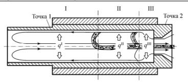
*Puc.* 5. Схема составного электрода–анода. I–III — характерные зоны тепловых потоков.
