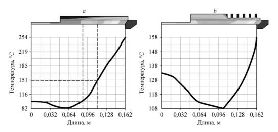
$Puc.\ 6.$  Распределение температуры по длине рабочей поверхности электрода. a — трубчатая стальная обечайка, b — конфигурация стальной обечайки с трапецеидальной резьбой.
