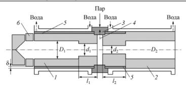
*Рис. 1.* Конструктивная схема пароводяного плазмотрона. 1 — анод, 2 — катод, 3 — изолятор, 4 — кольцо закрутки, 5 — стальная обечайка, 6 — изолятор.
