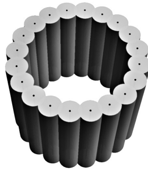
Рис. 1. Формирование ледопородного ограждения вокруг контура замораживающих скважин
