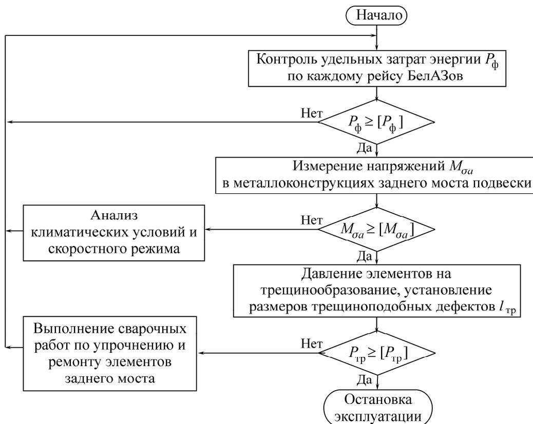
Рис. 9. Алгоритм по мониторингу ресурса металлоконструкций заднего моста подвески большегрузных автосамосвалов
