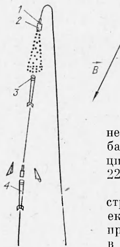
Рис. 5. Схема эксперимента «Сполох-2» с илжекцией кумулятивной струи в поносферу.
