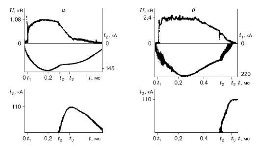
Рис. 2. Осциллограммы напряжения на электродах U(t), рабочего тока  $i_1(t)$ ,  $i_2(t)$  и тока в шунтирующей цепи  $i_3(t)$  при метании:
