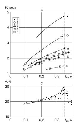
Рис. 4. Зависимости дульной скорости (a) и эффективности преобразования подведенной энергии в кинетическую (b) от длины ствола (обозначения те же, что на рис. 3)
