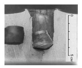
Рис. 5. Кратер в дюралюминиевой мишени со стальным ударником массой 60 г и сохранившимся лексановым поддоном массой 20 г при скорости соударения 1 км/с
