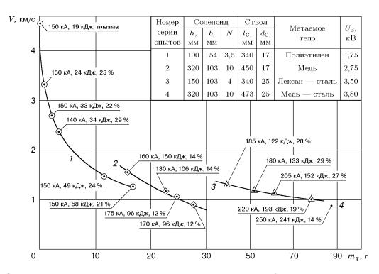
Рис. 6. Зависимость дульной скорости от массы метаемого тела (для каждой точки указаны максимальный ток, подведенная энергия, эффективность преобразования энергии)
