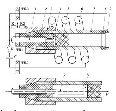
Рис. 1. Схема гибридной электромагнитной ускорительной системы:
