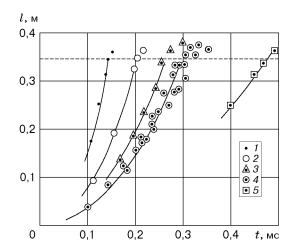
Рис. 3. Зависимость времени выхода тела из ствола от длины ствола ( $d_{\rm c}=17$  мм,  $U_3=1,75$  кВ):
