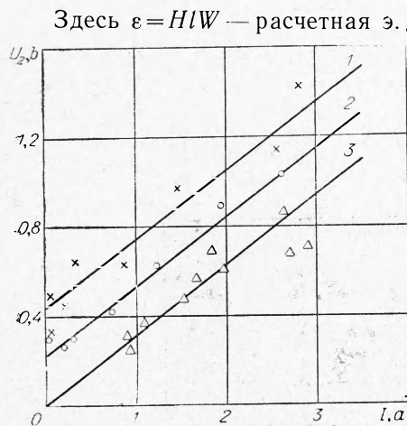
Рис. 3. Вольт-амперные характеристики межэлектродного промежутка. МГД-метод: 1 — H=750 э, 2 — H=589 э; электроконтактный метод: 3 — H=0 .
