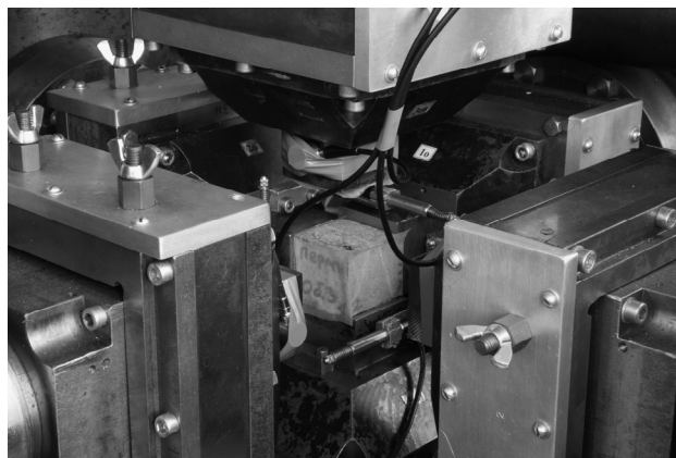
Рис. 1. Образец испытательной системы трехосного независимого нагружения после остановки испытания на сложное непропорциональное сжатие песчаника
