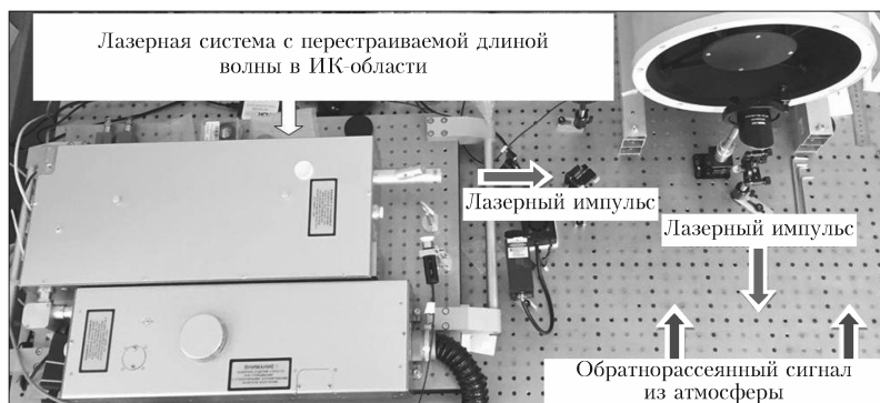
Рис. 1. ИК-лидарная система дифференциального поглощения
