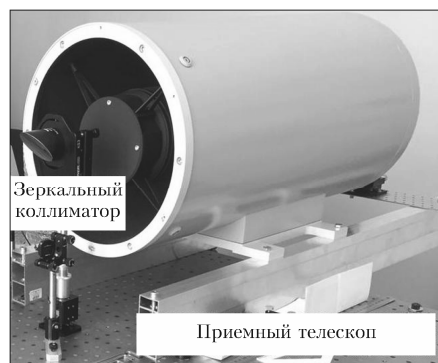
Рис. 2. Приемный телескоп и зеркальный коллиматор
