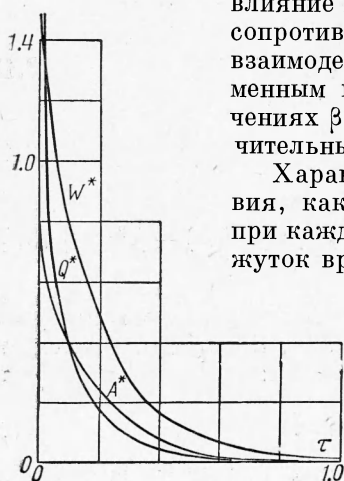
Фиг. 2. Зависимость работы плазмы за единицу времени A^* , интенсивности джоулевых потерь в плазме Q^* и энергии магнитного поля в системе W^* от времени при \beta = 2.5 и R_m = 6
