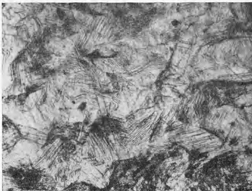
Рис. 2. Микроструктура на полированной поверхности после прохождения ударной волны.
