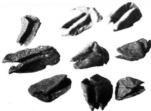
Рис. 3. Декрипитация пирита и арсенопирита при обжиге в атмосфере водяного пара
