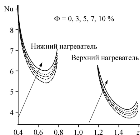
Рис. 11. Изменение локального числа Нуссельта при различных объемных долях наночастиц. \varepsilon = 1 , Ra = 10^4 .
