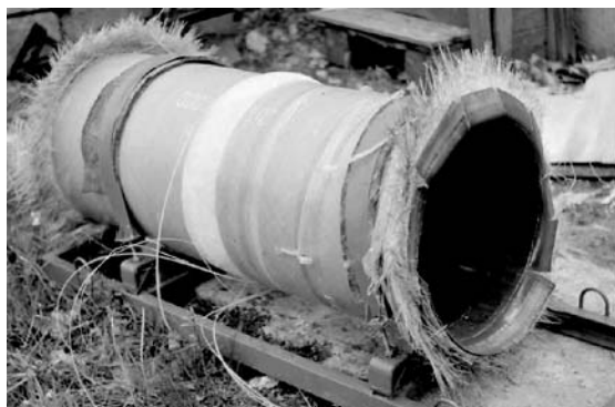
Рис. 6. Вид разрушенной модели № 4
